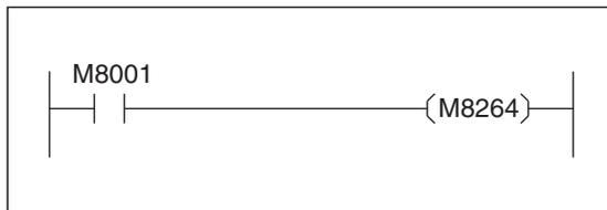
**Abb. 6-8:** Beim FX3G-1DA-ADP, das auf dem 1. Erweiterungssteckplatz installiert ist, wird der zuletzt gültige Analogwert auch bei einem Stopp der SPS ausgegeben. M8001 ist immer „0“.
